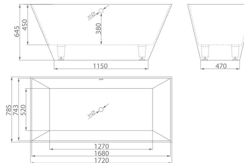
размеры/size, мм \_\_\_\_\_ 1720x785x645
