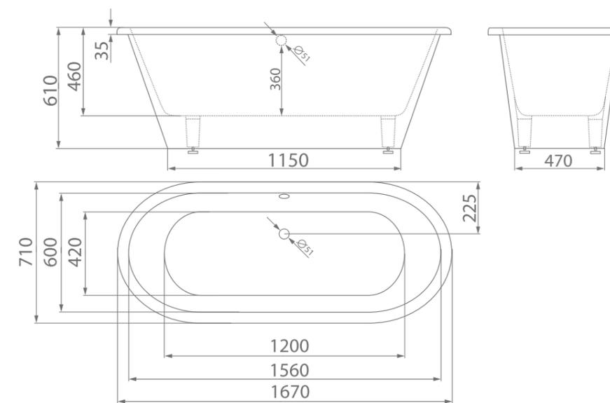
размеры/size, мм \_\_\_\_\_ 1670x710x610
