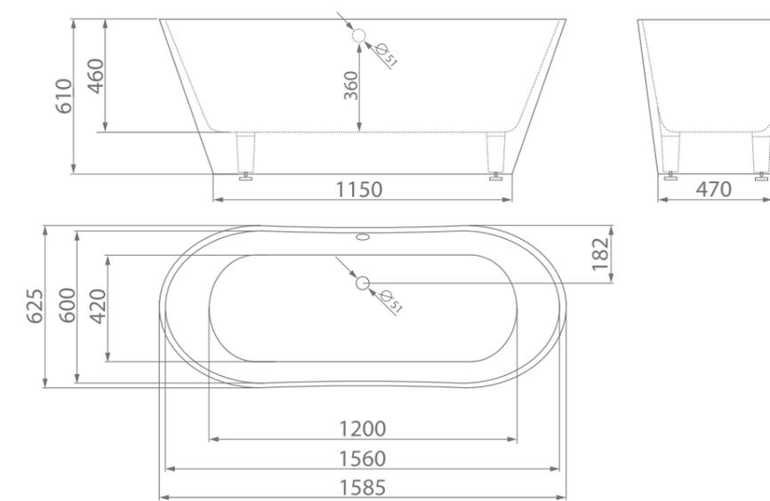
размеры/size, мм \_\_\_\_\_ 1585x625x610
