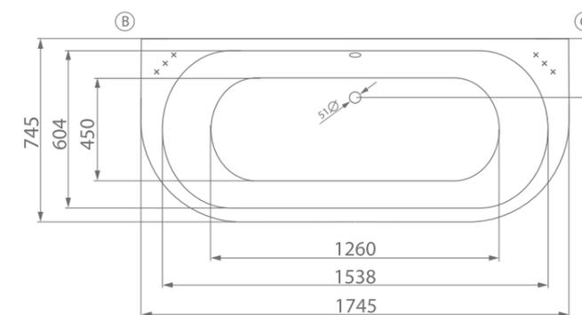
B, C - место врезки дополнительного оборудования.
