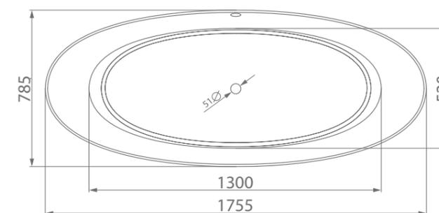
размеры/size, мм \_\_\_\_\_ 1755x785x710
