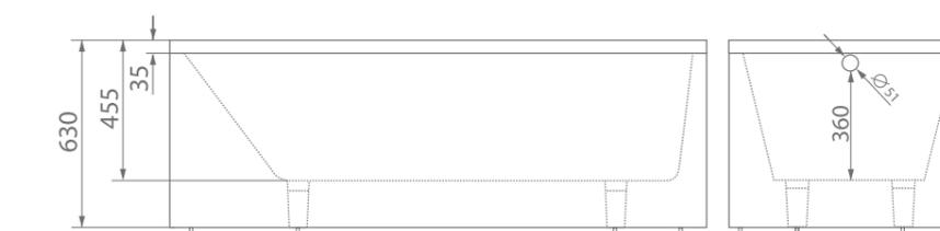
размеры/size, мм \_\_\_\_\_ 1600x790x630
