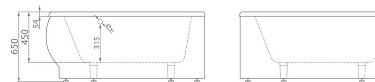
размеры/size, мм \_\_\_\_\_ 1455x1455x650
