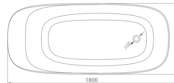
размеры/size, мм \_\_\_\_\_ 1800x800x610
