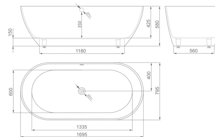
размеры/size, мм \_\_\_\_\_ 1695x795x580
