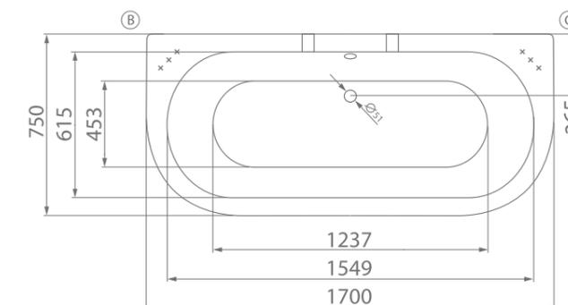
B, C - место врезки дополнительного оборудования.
