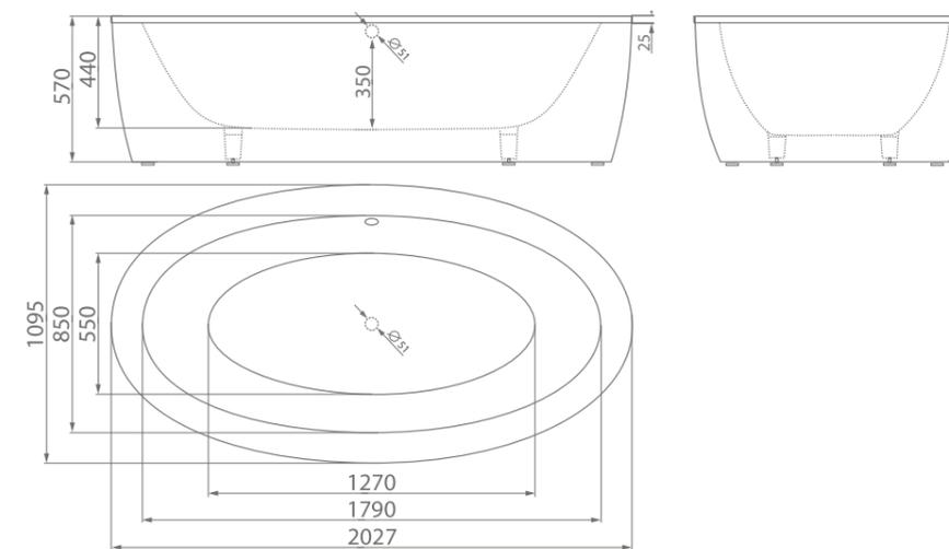
размеры/size, мм \_\_\_\_\_ 2027x1095x570
