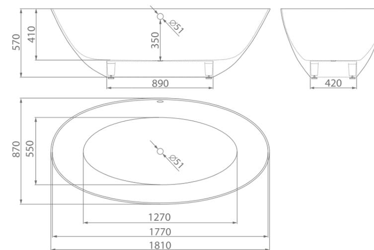
размеры/size, мм \_\_\_\_\_ 1810x870x570
