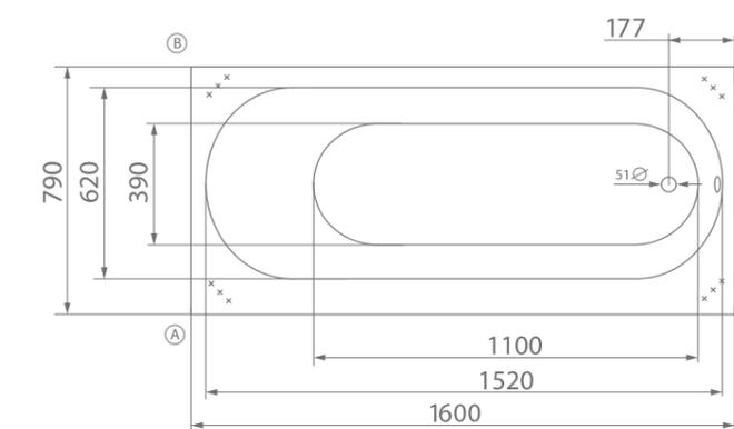
A, B, C, D - место врезки дополнительного оборудования.
