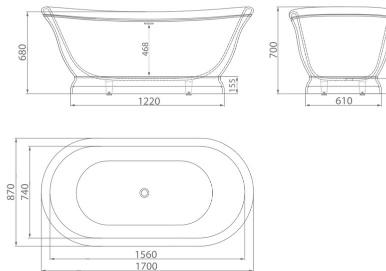
размеры/size, мм \_\_\_\_\_ 1700x870x700
