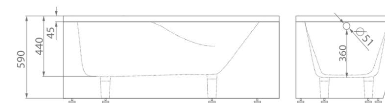
размеры/size, мм \_\_\_\_\_ 1600x740x590
