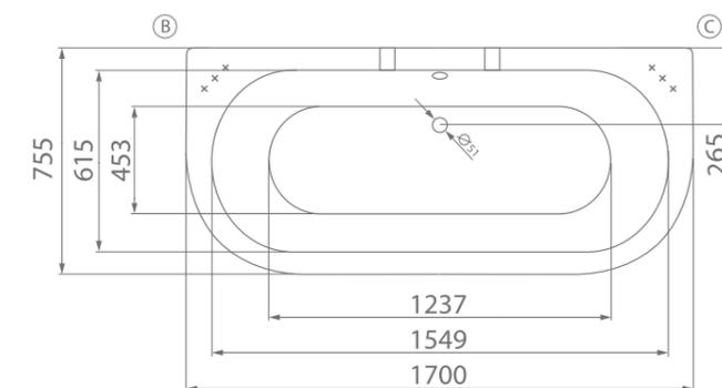
В, С - место врезки дополнительного оборудования.
