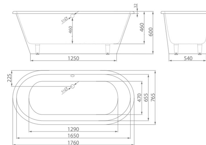
размеры/size, мм \_\_\_\_\_ 1760x765x600
