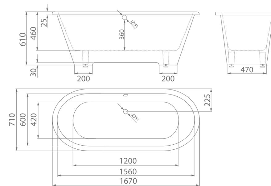
размеры/size, мм \_\_\_\_\_ 1670x710x610
